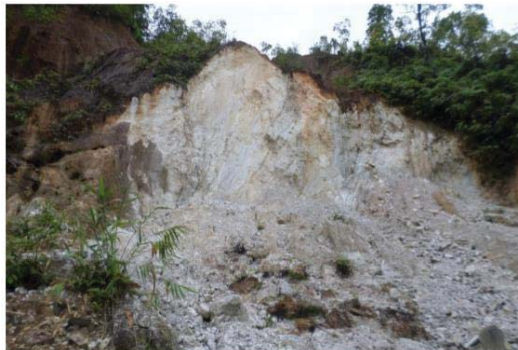
ภาพประกอบที่ 27 แสดงลักษณะของหินแกรนิตผุหรือแร่ดินขาวทางทิศใต้ของพื้นที่คำขอประทานบัตรที่ 4/2550 (ถ่ายบริเวณพิกัด 465088 E 1098200 N L 7018 ไปทางทิศเหนือ)
