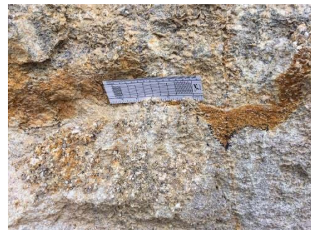
ภาพประกอบที่ 18 ลักษณะเนื้อหินแกรนิตผุที่ให้แร่ดินขาวบริเวณพื้นที่คำขอประทานบัตรที่ 1/2560 (ถ่ายบริเวณพิกัด 464502 E 1098395 N L7018)
