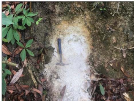
ภาพประกอบที่ 23 ลักษณะเนื้อหินแกรนิตผุที่ให้แร่ดินขาวบริเวณพื้นที่คำขอประทานบัตรที่ 2/2558 (ถ่ายบริเวณพิกัด 464627 E 1098216 N L7018)
