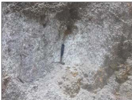
ภาพประกอบที่ 18 ลักษณะเนื้อหินแกรนิตผุที่ให้แร่ดินขาวบริเวณพื้นที่คำขอประทานบัตรที่ 1/2560 (ถ่ายบริเวณพิกัด 464502 E 1098395 N L7018)
